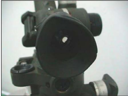
Luneta de focagem fixa, com um poder de ampliação de 4 vezes, o retículo é um vidro gravado com uma linha horizontal e outra vertical cruzando-se no centro, graduados a partir desse ponto de 5 em 5 mil, desde 0 a 85 mil, e numeradas de 10 em 10 mil.
