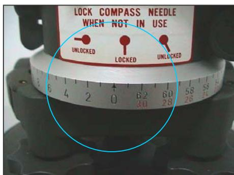
É um mecanismo dos movimentos particulares. Permite grandes e pequenos movimentos azimutais. Os grandes movimentos conseguem-se puxando ou empurrando (conforme a posição do operador) lateralmente o parafuso dos movimentos particulares. Os pequenos, simplesmente rodando o mesmo parafuso.
