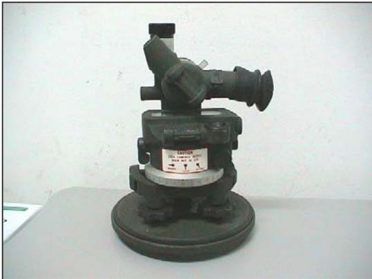
O goniómetro-bússola **M2A2** é um teodolito fácil de operar, destinado ao uso nas baterias de bocas de fogo (para dar pontarias) e em levantamentos topográficos executados com uma precisão de 1 :500 (não é usado se a precisão requerida for superior).
