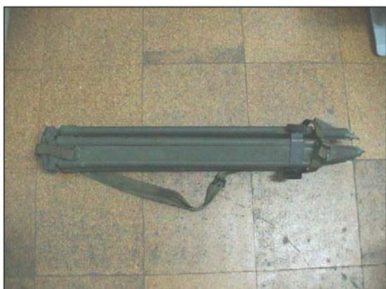
O tripé tem 3 pernas telescópicas, Placa e Tampa de Alumínio e uma correia para transporte (bandoleira). O comprimento das pernas é ajustável através dos parafusos de orelhas que se apertam para prender as pernas e manter assim o comprimento adequado. As dobradiças que unem as pernas à placa do tripé são ajustáveis para maior ou menor fricção, por parafusos na parte inferior da placa. As pernas terminam num
