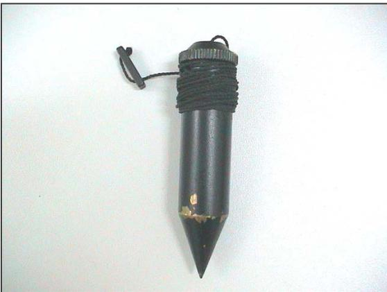
Quando é necessário, suspende-se dum gancho existente no parafuso de fixação do aparelho ao tripé. Normalmente está preso numa presilha da bolsa de lona.
