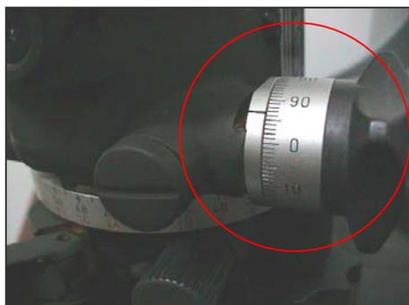
A escala azimutal é graduada desde 0 a 6400 milésimos, graduada de 100 em 100, e numerada de 200 em 200. Entre 3200 e 6400 existe outra escala, por baixo da primeira, com números a vermelho desde 0 a 3200. Só a escala superior (primária) é usada nas operações topográficas. O tambor azimutal está situado no parafuso dos movimentos particulares (azimutais), é graduado em milésimos de 0 a 100 e numerado de 10 em 10.
