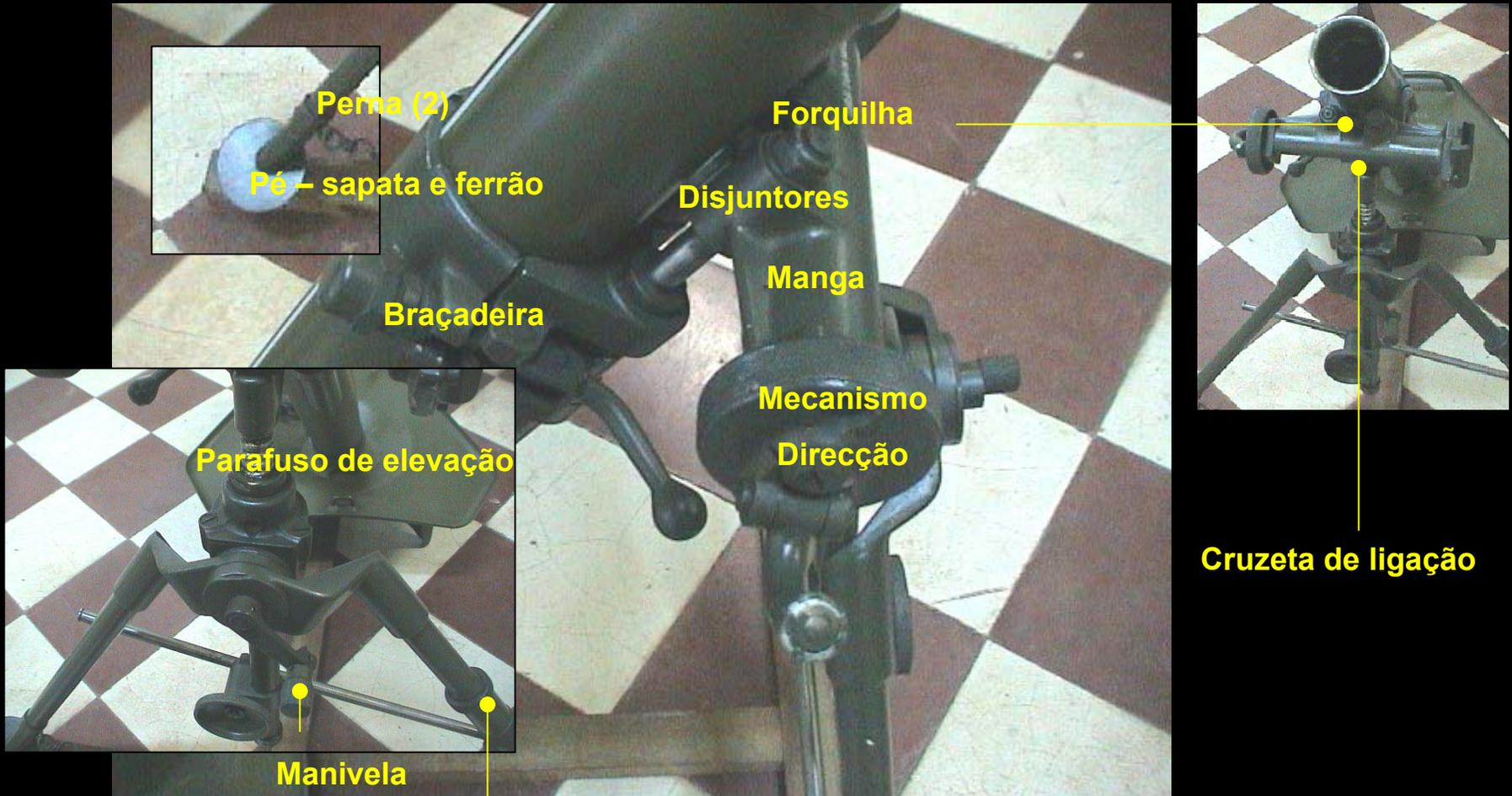
**Mecanismo Nivelador** – Manter horizontalidade do Mecanismo direcção
