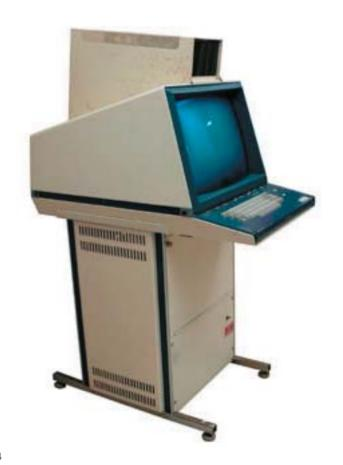
independentemente cada um dos dois eixos X e Y. O sistema tinha cinco terminais gráficos e foi principalmente usado para a geração de programas de maquinação 3D de zonas moldantes em diversas máquinas ferramentas programáveis e centros de maquinação do grupo Iberomoldes, a partir de modelos geométricos ("wireframe", modelos de arames) da peca a moldar.
