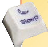
Eis um exemplo de uma tecla ACPI, para "adormecer" o computador quando não é utilizado durante algum tempo e, desta forma, poupar energia.
