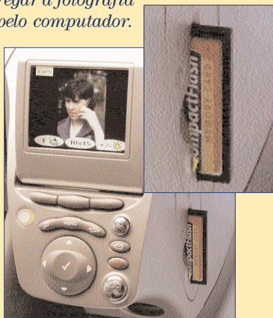
Certos modelos permitem imprimir directamente as fotografias, inserindo os cartões de memória da máquina fotográfica digital na ranhura da impressora.
