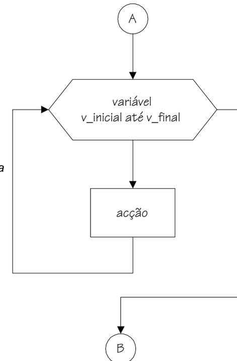
Aqui é apresentada uma aplicação desta estrutura. A variável *contagem* é utilizada como contador. A não indicação do passo leva a que o valor seguinte de *contagem* será o valor anterior mais um.
