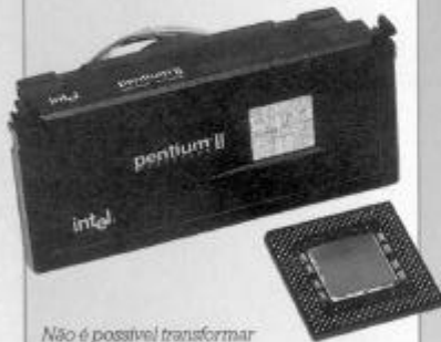
Não é possível transformar um computador MMX num Pentium II. As duas tecnologias são diferentes, como o mostra claramente esta fotografia.
